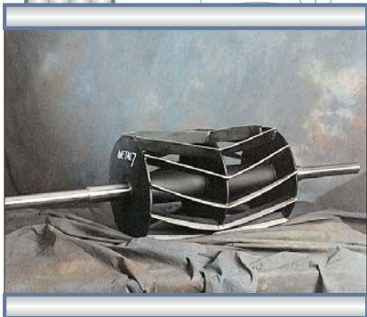
Roues de mélangeur avec revêtement sur les pales.
