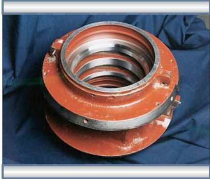
Réfection d'un palier lisse à régule (babbitt).
