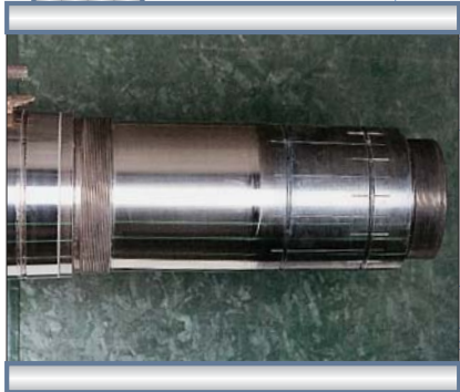
Réparation d'une portée de joint mécanique d'un arbre de raffineur.
